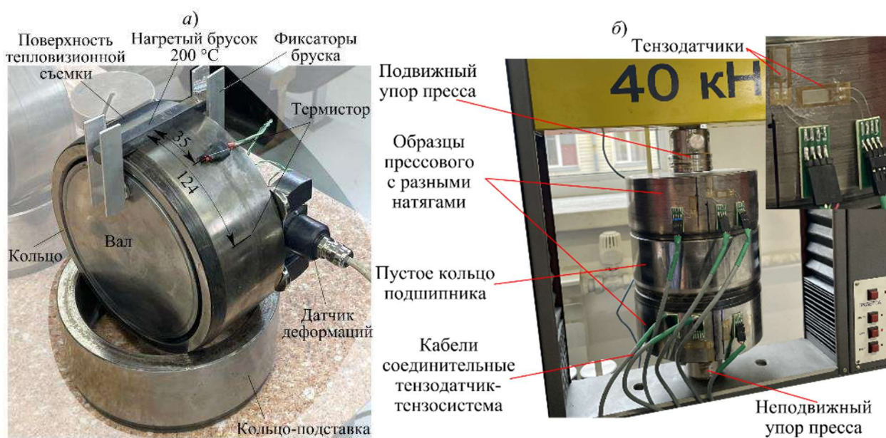
Рис. 6 – Схема испытаний при тепловом (а) и механическом (б) нагружении
