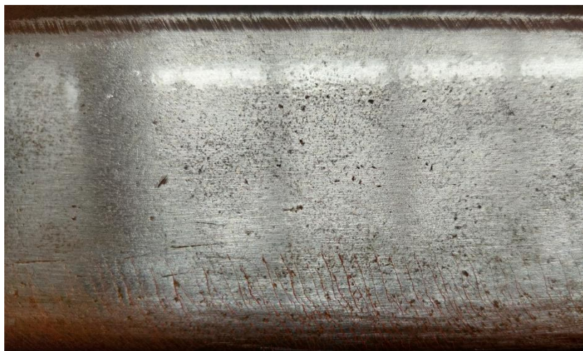
Контактно-усталостные трещины на поверхности головки рельса
