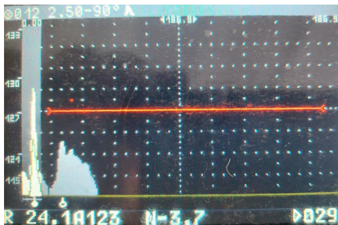
Амплитуда сигналов от трещин при настройке чувствительности на -15 дБ от торца преобразователя 2,5 МГц
