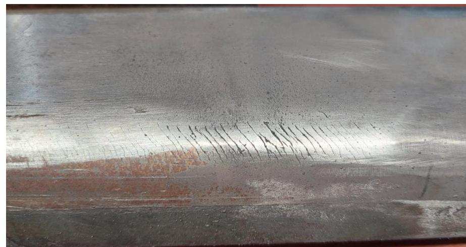
Контактно-усталостные трещины в рабочей грани головки рельса
