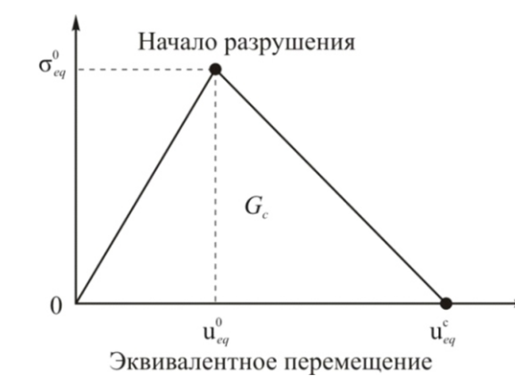
Рис. 3 - Определяющие соотношения для трансверсально-изотропного поврежденного материала и закон развития повреждений
