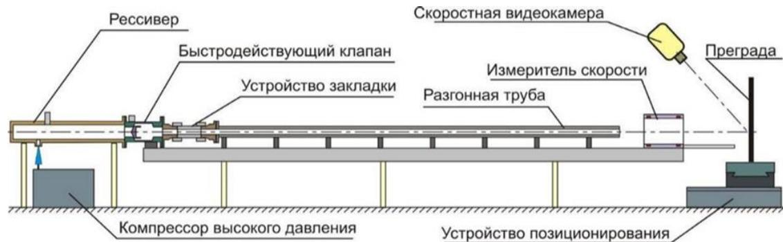
Пневматическая установка для разгона стального ударника
